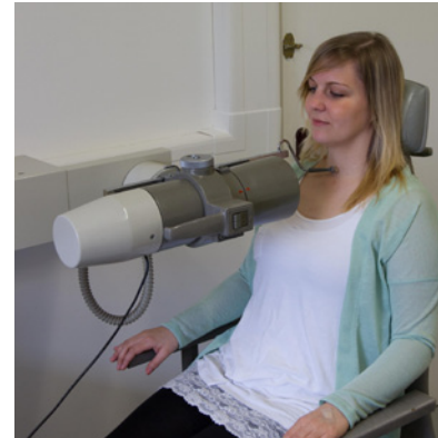
Messvorgang beim Radioiodtest: Die radioaktive Strahlung in der Schilddrüse wird über einen Zeitraum von einer Minute mit Hilfe dieses Messgerätes erfasst.
